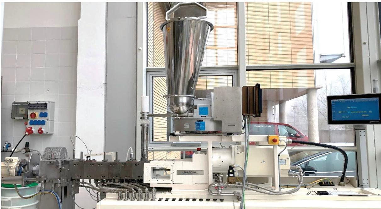
Abb. 3: Doppelschneckenextruder (Gunawan, 2021)
