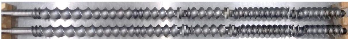
Abb. 2: Zweite Schneckenkonfiguration (Cîrstea, 2020)
