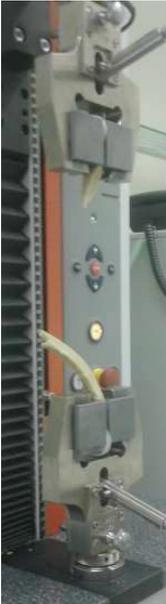
Abb. 18: Probe am Ende des Zugversuchs.
