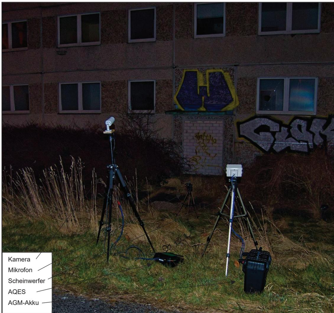
Abbildung 11: AQES Prototyp während eines Testaufbaus.
