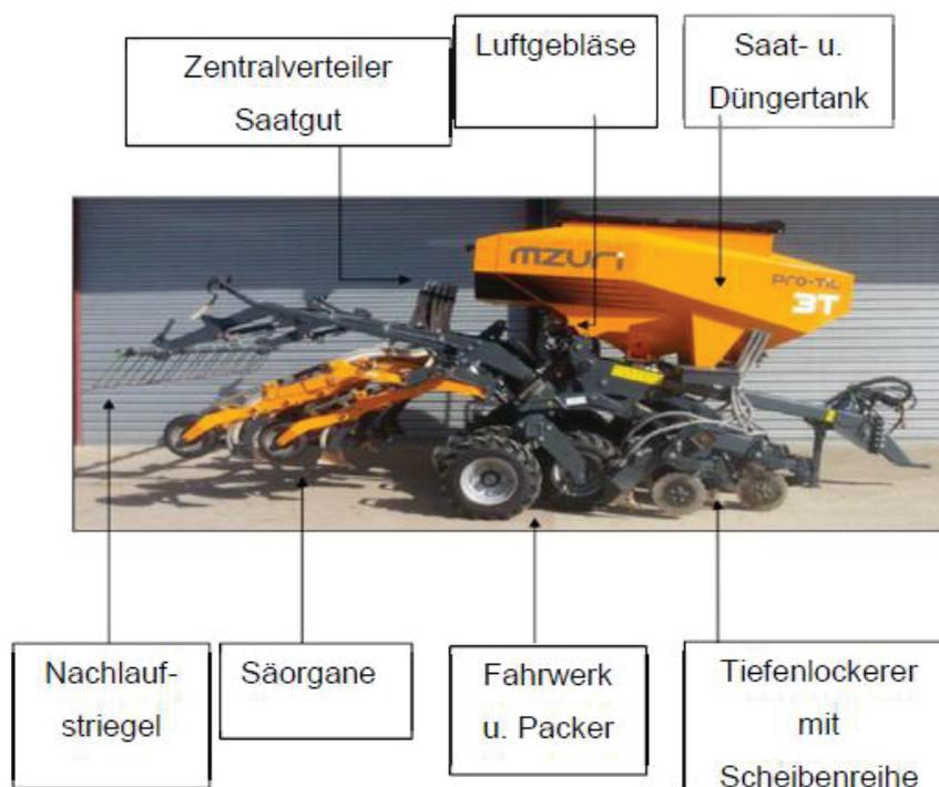
Abbildung 2: Aufbau der Mzuri Pro-Til. Quelle: Reinhart, 2017.
