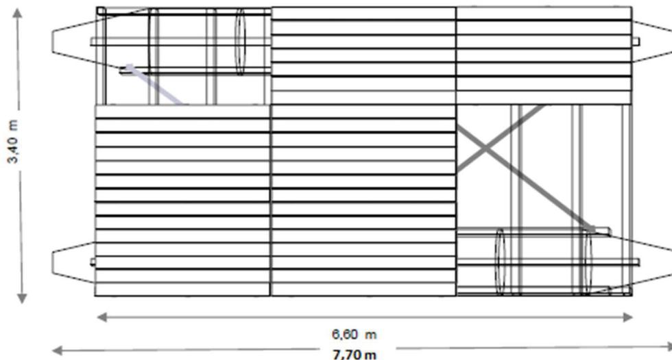
Abbildung 11: Grundriss der Schwimmplattformen
