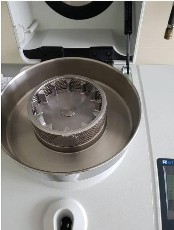
Abbildung 13: 1 mm Lochscheibe eingesetzt in der Zentrifugalmühle (Büssow, 30.06.2018).
