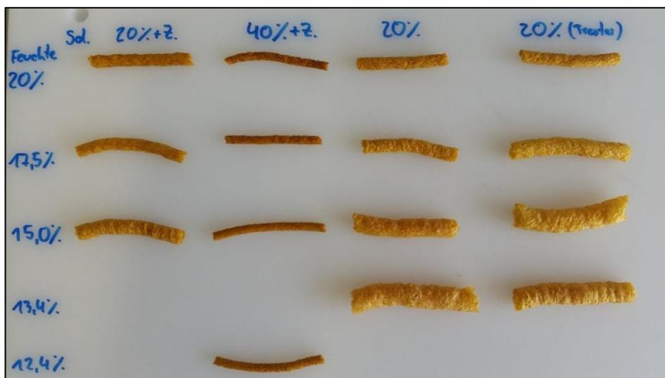
Abbildung 13: Extrudate Vorversuch II
