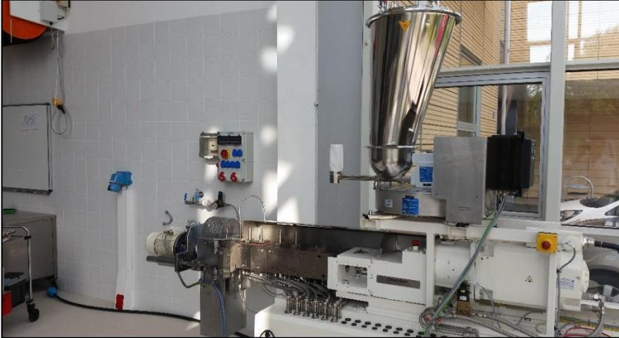
Abbildung 5: Doppelschneckenextruder
