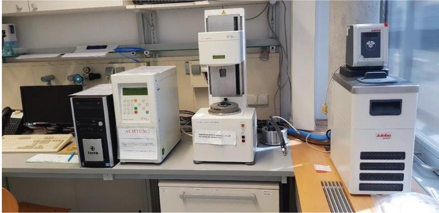
Anlage 14: Messanlage des Rotationsviskosimeters MC 100 und der Auswertungssoftware Rheolab UDS 200 der Firma Physica
