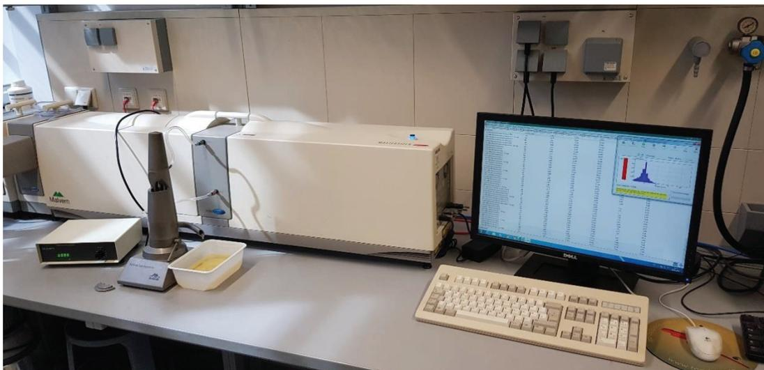
Anlage 13: Messanlage der Laserbeugungsspektrometer Mastersizer 2000 der Firma Malvern Instruments
