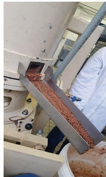
Abbildung 18: Entfernen des blockierten Produkts mit den Kugeln
