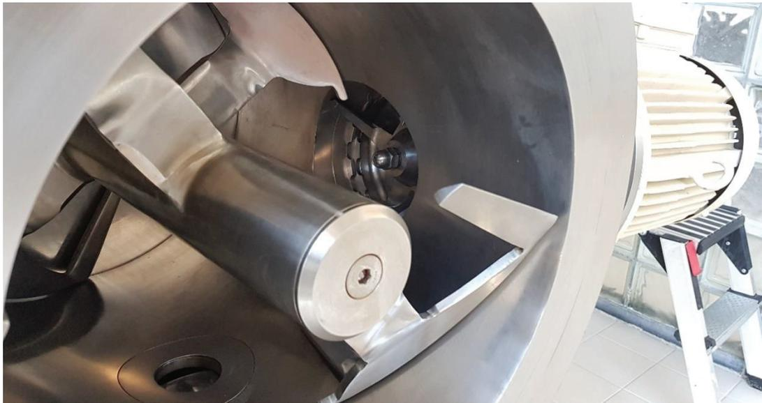
Anlage 12: Conche und Wirbelkammer der Firma Lipp Mischtechnik (IMC- E 30)
