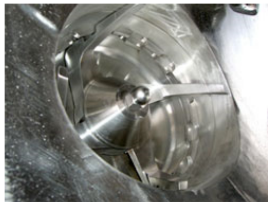
Abbildung 6: Wirbelkammer (Quelle: http://www.lippmischtechnik.de/de/wirkprinzipien/wirbelkammer/ )
