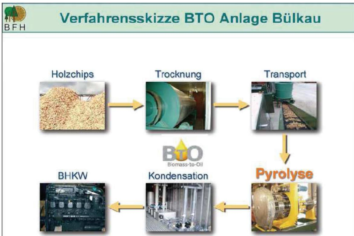
**Abbildung 5:** Visualisierter Flash-Pyrolyse-Ablauf für den Rohstoff Holz zeigen die Containerstruktur der zur Umsetzung errichteten BTO-Pilotanlage in Bülkau.
