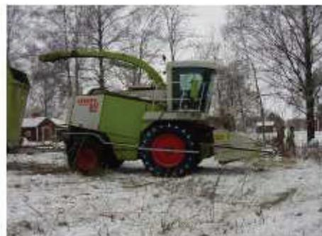
Abbildung 4: Selbstfahrender Mähähcksler mit umgebauten Weidengebiss
