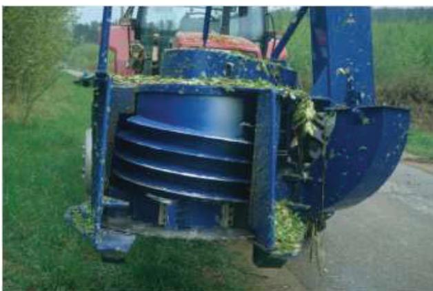
Abbildung 9: Hackaggregat des Gehölzmähähäckslers
