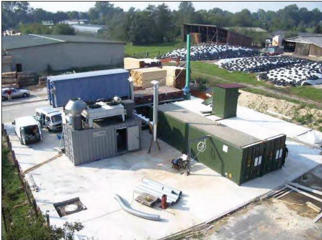
**Abbildung 6:** Containeranlage für die Flash-Pyrolyse des Rohstoffs Holz
