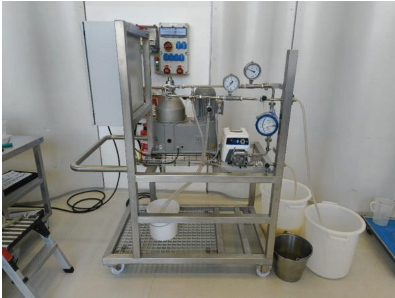
Abb. 34: Separatoranlage mit Pumpe im Einsatz (eigene Aufnahme)
