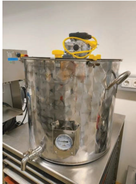
Abb. 35: Eingesetzter Kochkessel mit Rührwerk (eigene Aufnahme)
