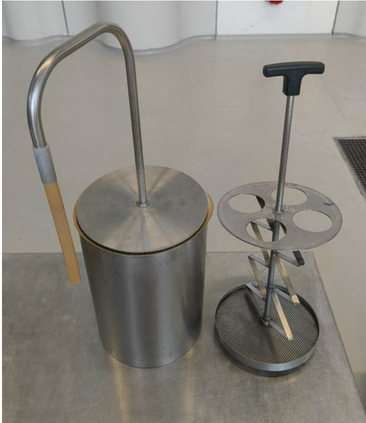
Abb. 11: Einsätze für die Brauereianlage. Links: Whirlpooleinsatz, Rechts: Siebboden mit Aufhackwerk (eigene Aufnahme)
