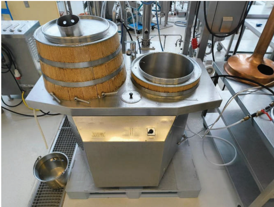
Abb. 10: Brauereianlage „Brixonia 20 T Serie“ (Rational Beratungsges. mbH / ROSOMA GmbH, Deutschland, Rostock 1996). Auf der Anlage links: Maische-/Würzepfanne, rechts: Läuterbottich sowie firmeneigener Volumenmessstab (eigene Aufnahme)
