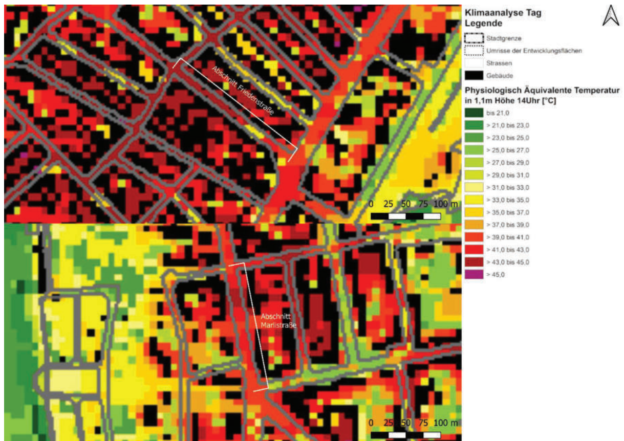
Abbildung 7: Ausschnitt Klimaanalysekarte Tag – PET zum Zeitpunkt 14:00 Uhr in 1,1 m Höhe (Hansestadt Lübeck, 2026b)
