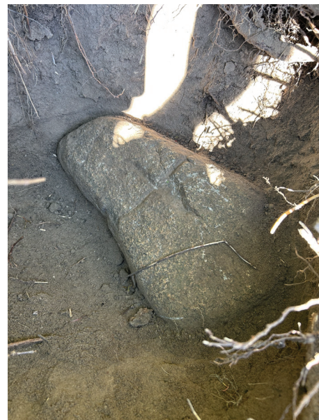
Abbildung 37: Vorgefundener Grenzpunkt der Neumesung von 1869, vermarktet durch einen Granitstein mit eingehauenen Kreuz.
