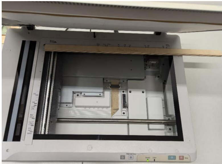
Abbildung 7: Scanner für hochauflösende Fotos der Bohrkerne (Foto: Möller, 2024)
