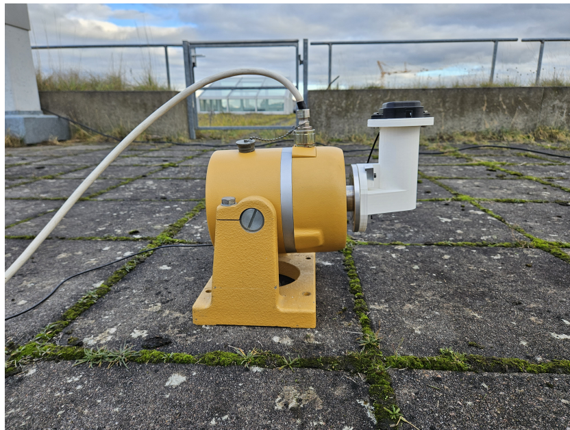
Abbildung 4.20: Messaufbau Schwingungserzeuger mit Low-Cost-GNSS-System als Sensor
