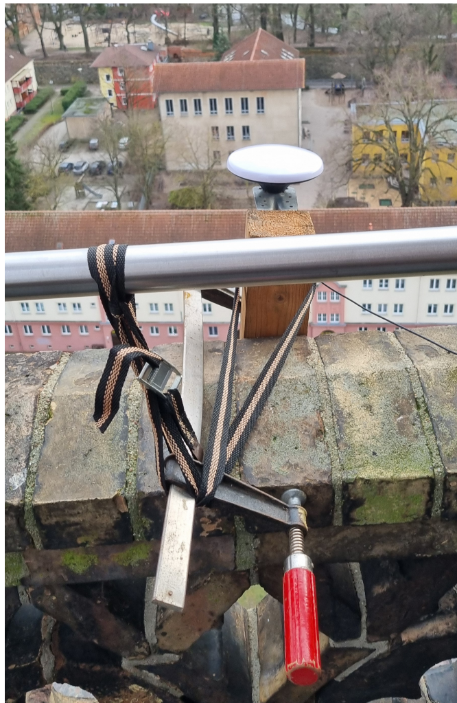
Abbildung 4.40: Realdaten: GNSS-Antenne an der Marienkirche Neubrandenburg im Jahr 2024
