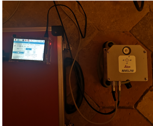
Abbildung 4.37: Realdaten: Leica Nivel210 am Messort in der St.-Petri-Kirche Altentreptow 2022
