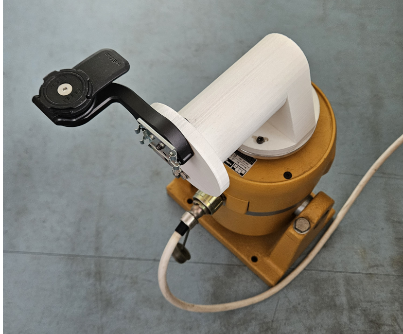
Abbildung 4.21: Messaufbau Schwingungserzeuger mit Smartphone-Halterung zur Beschleunigungsmessung
