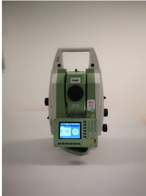
Abbildung 4.18: Leica TM30, Präzisionstachymeter, speziell für Anwendungen in der Bauwerksüberwachung
