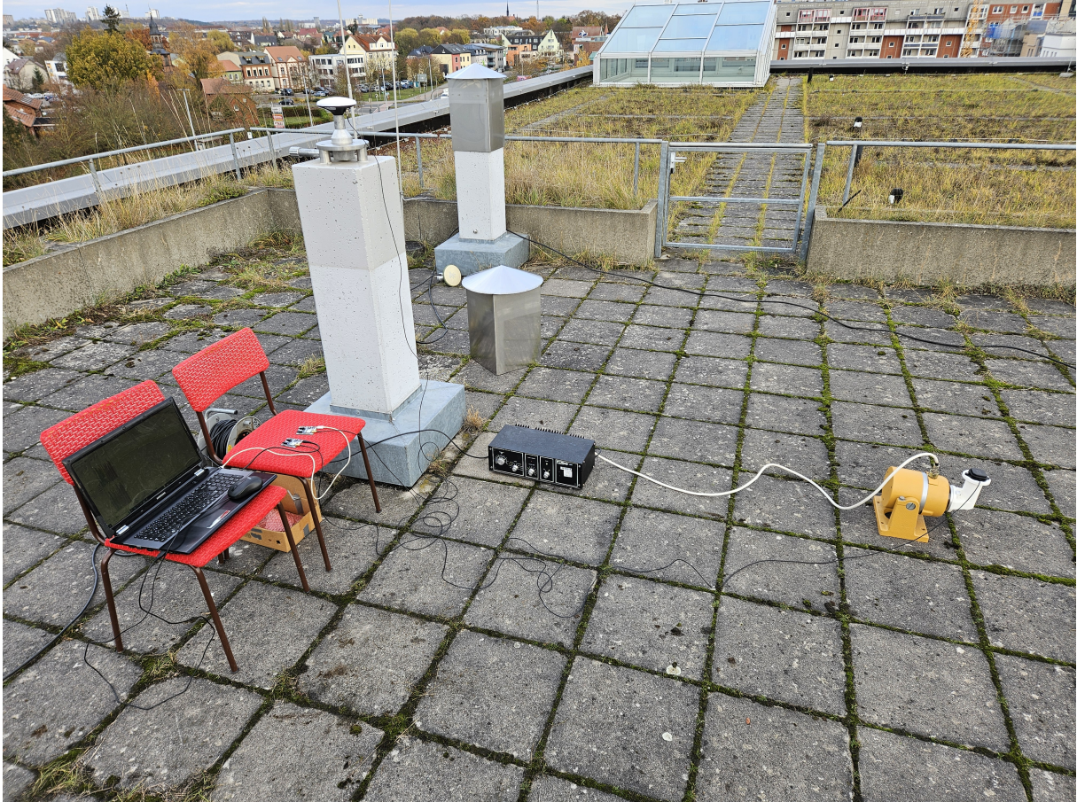
Abbildung 4.22: Messaufbau Laboruntersuchungen Low-Cost-GNSS auf dem Dach der Hochschule Neubrandenburg
