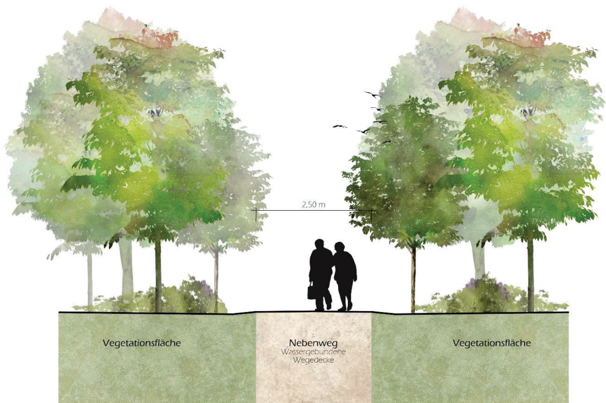
Abb. 48: Konzeptschnitt Nebenwege ( eigene Visualisierung, 2024 )
