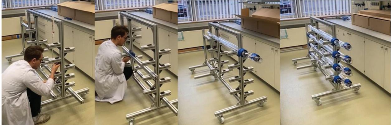
Abbildung 12: Vorbereitung und Installation des Glasröhren-Systems auf dem Gestell (Eigene Aufnahmen)
