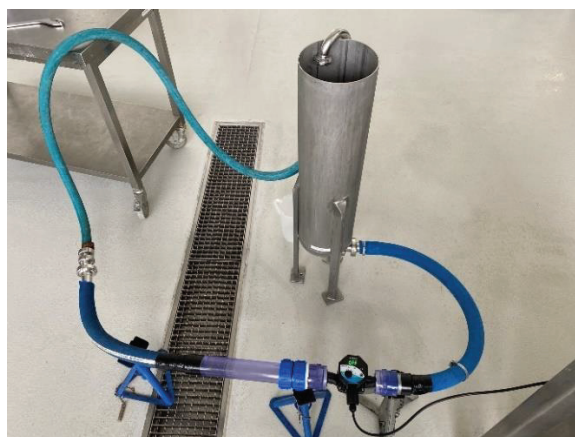
Abbildung 29: Experimenteller Aufbau zur Untersuchung der Pumpcharakteristiken (Eigene Aufnahme)
