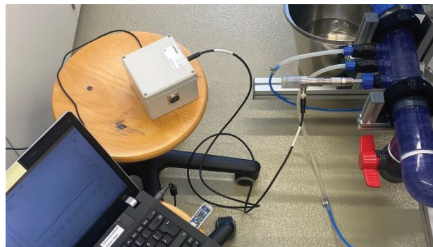
Abbildung 40: Experimenteller Aufbau für die Bestimmung des kLa (Eigene Aufnahme)
