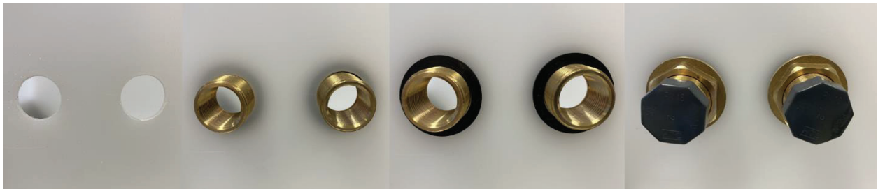
Abbildung 16: Installations-Reihenfolge der Tankdurchführungen für Messsonden und Überdruckventil (Eigene Aufnahmen)
