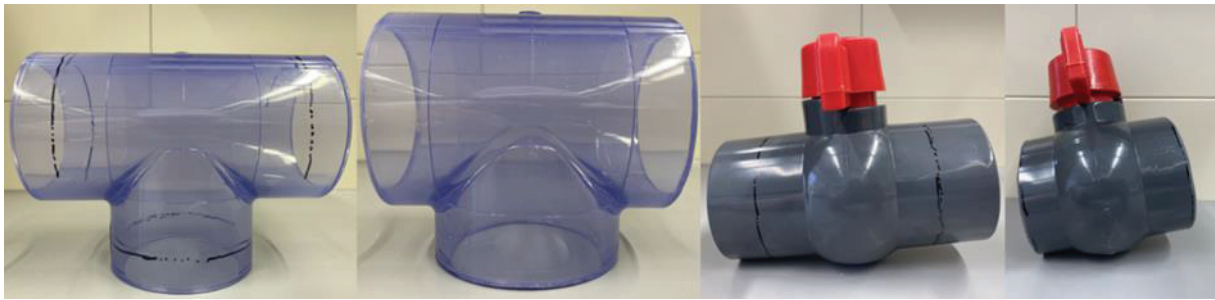
Abbildung 18: Bauteil-Anpassungen, um platzeinschränkende Gegebenheiten gerecht zu werden (Eigene Aufnahmen)
