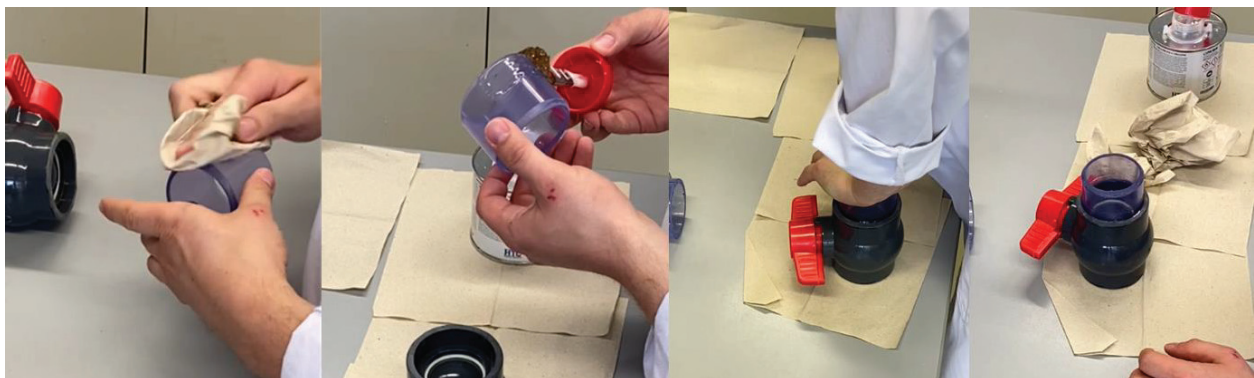
Abbildung 19: Prozess der Stift-Verklebung mit einer Klebemuffe (Eigene Aufnahmen)
