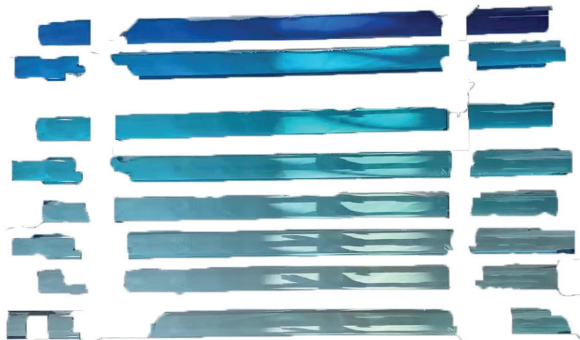
Abbildung 44: Spiegelung auf den Glasröhren von III, 200 (1) als beispielhafter Störfaktor (Eigene Aufnahme)
