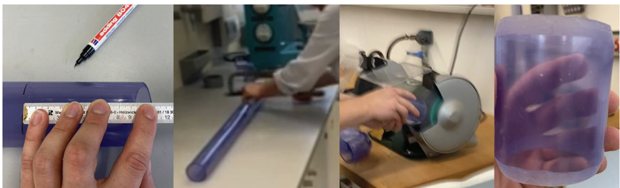
Abbildung 17: Stift-Herstellungsprozess für die Röhrenstrecken-Konstruktion (Eigene Aufnahmen)
