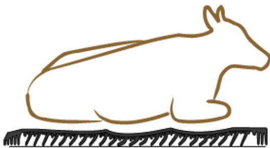
Abbildung 6 Schematische Verformung der Gummimattenstruktur bei Belastung durch Liegen
