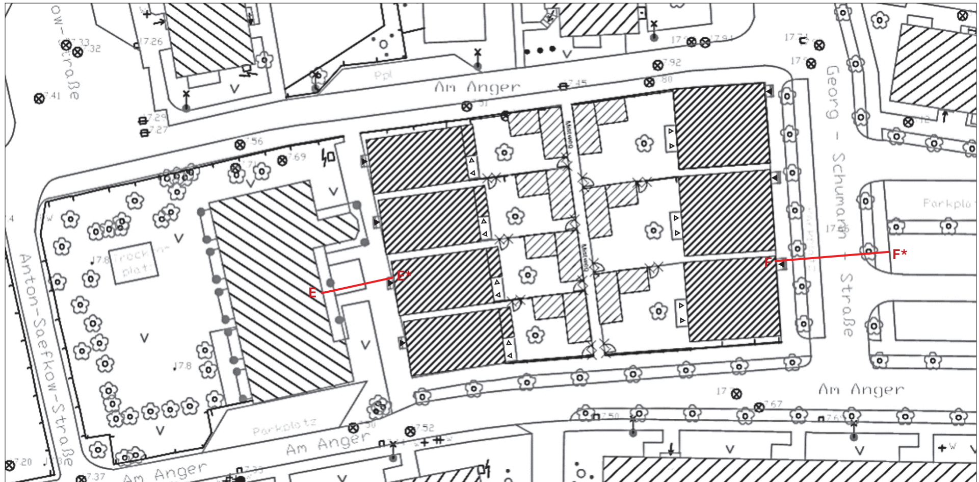
Abbildung 20: Von vorne machen je 80 Zentimeter breite Zwischen, von hinten ein 1,20 Meter breiter Mistweg den Hof zugänglich. Tore in den Grenzzäunen ermöglichen einen Zugang unter den Nachbargrundstücken. Blau eingezeichnet die Straßenschnitte E – E* (Abb. 21) und F – F* (Abb. 25). Maßstab unbekannt. Quelle: Eigene Darstellung auf Grundlage der Stadtgrundkarte Neubrandenburg.
