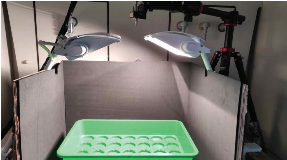
Abbildung 9: Messplatz mit der Messschale in dem mit Moosgummi ausgekleideten Karton, zwei Halogenlampen und dem Sensor des Spektrometers
