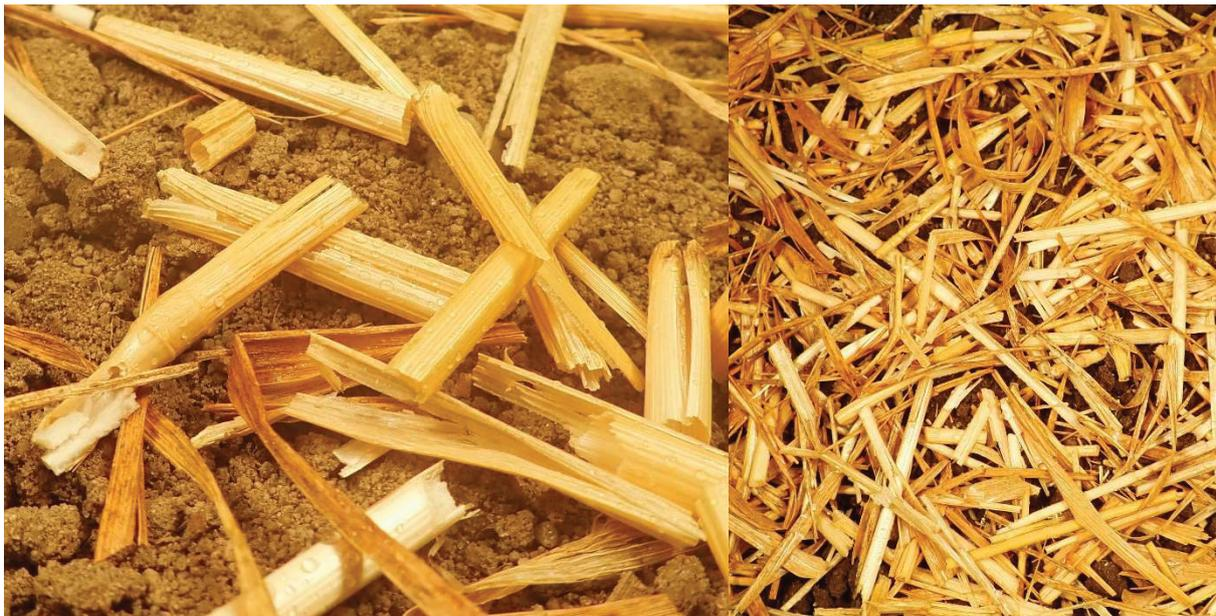
Abbildung 13: Aufnahmen aus dem Beregnungsversuch; links: Nahaufnahme nachdem Tau in Form von 0,07 l/m<sup>2</sup> auf 5 dt/ha Stroh gesprüht wurde; rechts: 20 dt/ha Stroh nach der Beregnung mit 5 l/m<sup>2</sup>
