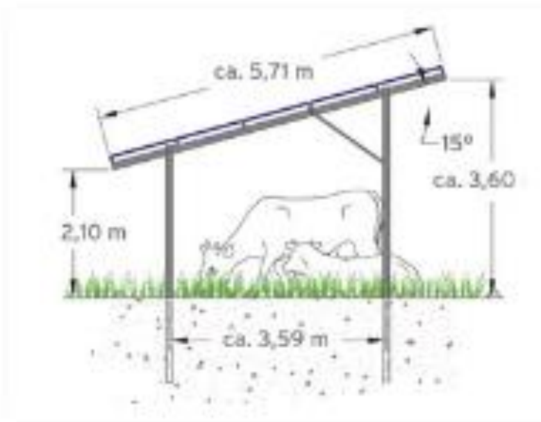
Abbildung 22: Abmessungen einer Agri- PV Anlage (SunFarming 2024)
