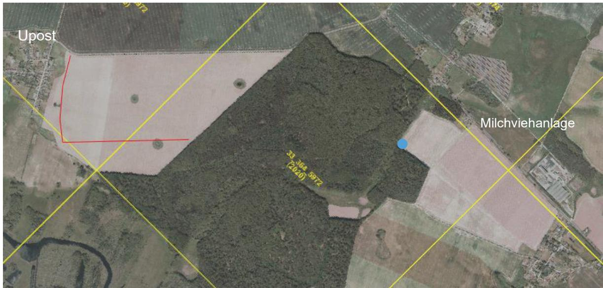
Abbildung 19: Leitung Upost blauer Punkt= Ende des Bewässerungsnetzes
