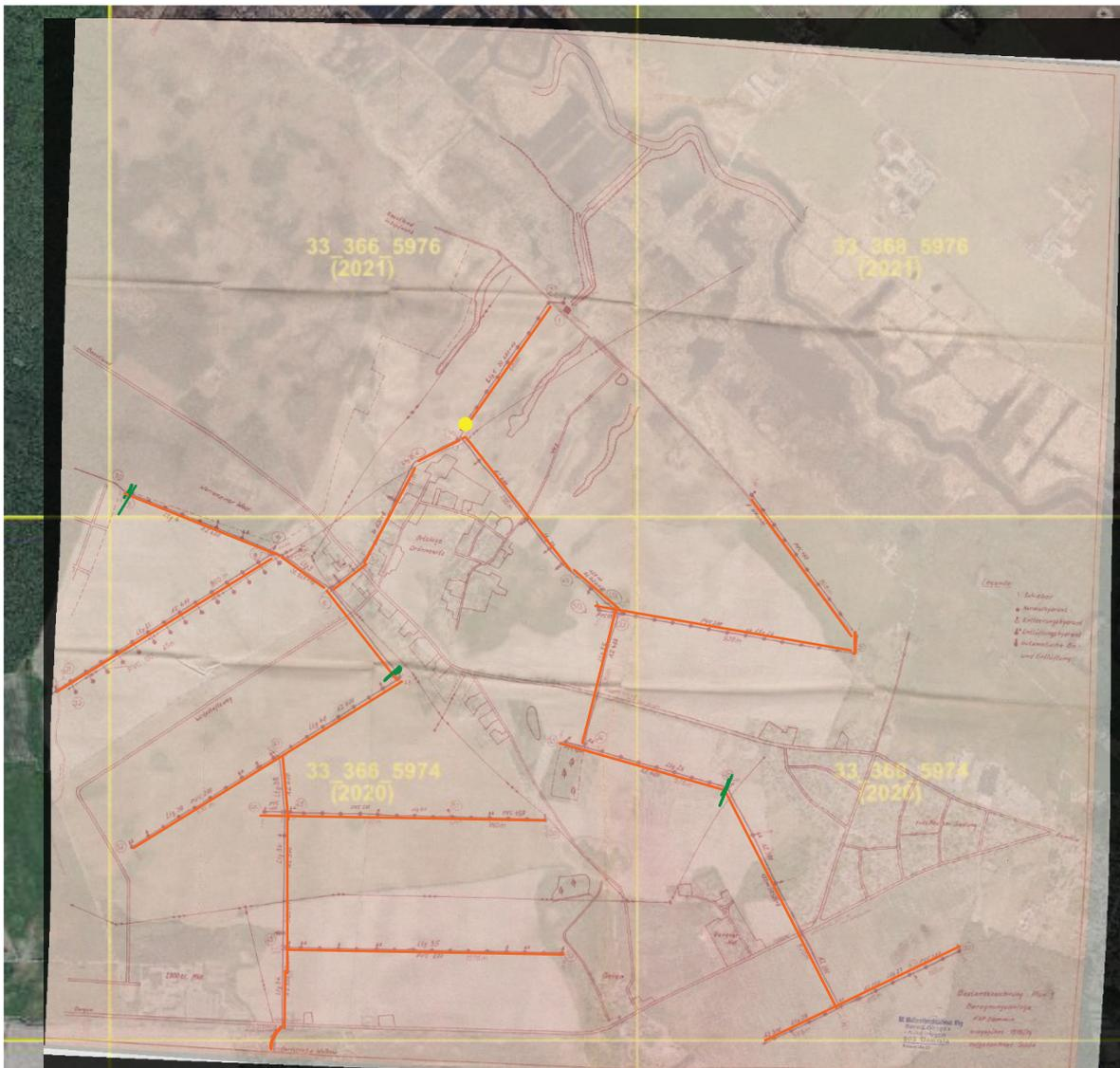
Abbildung 14: „Bestandszeichnung Plan 1“ Verlauf des Leitungsnetzes im Abschnitt Hauptteil auf georeferenzierter Bestandskarte über Orthophotos aus dem Jahr 2020 und 2021 gelber Punkt= Kreuzung mit Gasleitung, grüne Linien = Empfehlung für Schieberplatzierung
