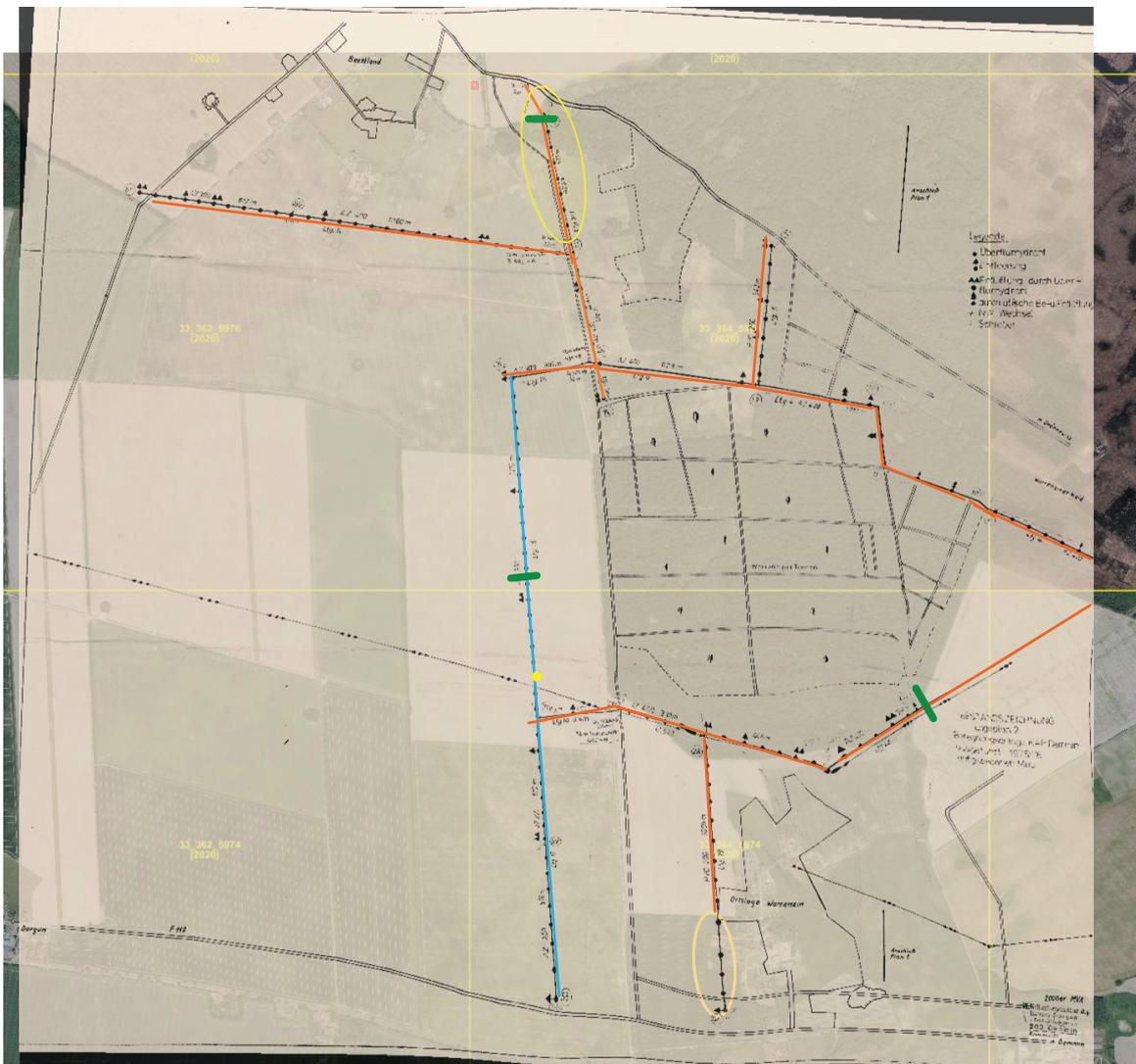
Abbildung 15: „Bestandszeichnung Lageplan 2“ Verlaufsplan des Leitungsnetzes im Abschnitt Warrenzin auf georeferenzierter Bestandskarte über Orthophotos aus dem Jahr 2020 und 2021 gelber Punkt= Kreuzung mit Gasleitung, gelbe Ellipsen= Leitung nicht mehr vorhanden (unten)Hydranten nicht mehr vorhanden(oben), grüne Linien = Empfehlung für Schieberplatzierung, orange Linien u. blaue= Markierung der Leitungen
