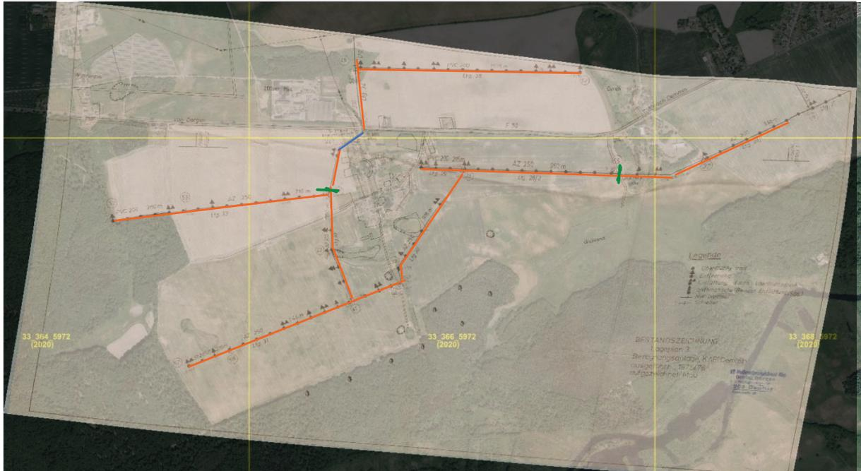
Abbildung 16: „Bestandszeichnung Lageplan 3“ Verlauf des Leitungsnetzes im Abschnitt Wolkow und Deven auf georeferenzierter Bestandskarte über Orthophotos aus dem Jahr 2020 und 2021, grüne Linien = Empfehlung für Schieberplatzierung, orange Linien = Markierung der Leitungen, blaue Linie = Leitung durch Ortslage
