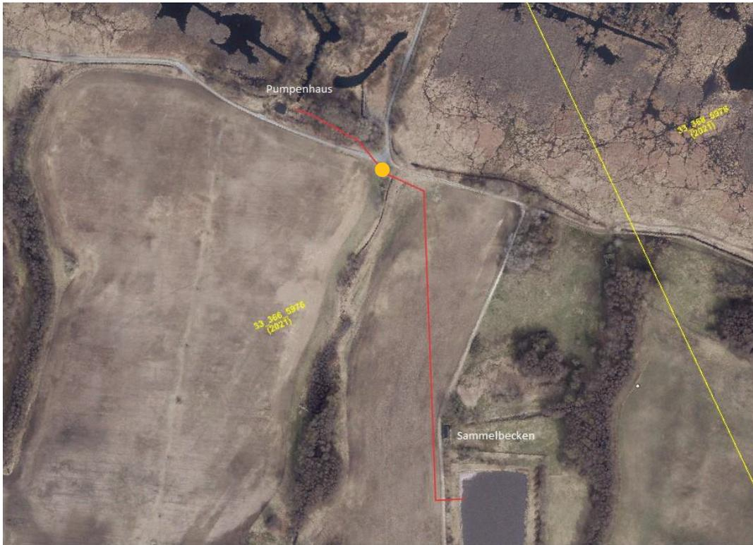
Abbildung 17: Verlauf der Leitung vom Sammelbecken zum Pumpenhaus, oranger Punkt = Kreuzung mit Gasleitung
