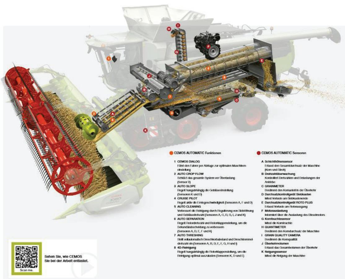
**Abbildung 10: Fahrerassistenzsysteme im Claas Mähdrescher**
