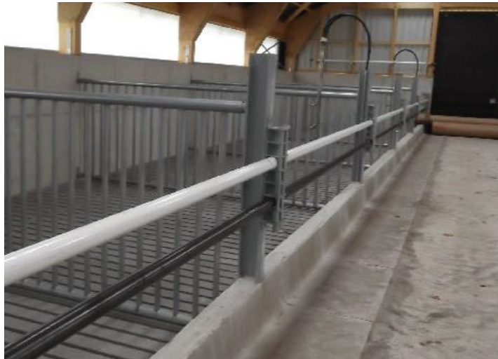
Abbildung 1: Höhenverstellbare Nackenrohrhalterung (Germing Stalltechnik, 2018)
