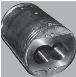
Abbildung 2: Gehäuse Doppelschneckenextruder (Berk, 2013)
