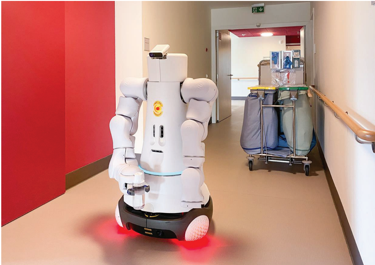
Abbildung 3: Serviceroboter Care-O-bot® 4 für den Einsatz in Pflegeheimen Entnommen aus (Fraunhofer IPA 2021a, o. S.)
