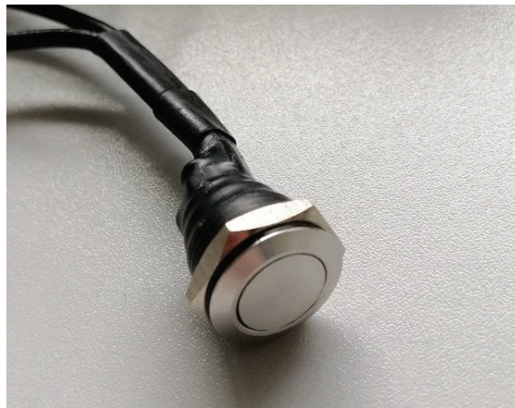
Abbildung 14: Drucktaster, ausgelegt als Schließer (eigene Aufnahme)
