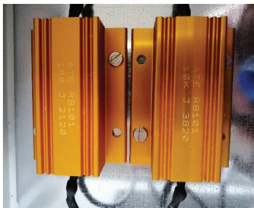
Abbildung 13: Hochlastwiderstände, links mit 1 \Omega , rechts mit 10.000 \Omega (eigene Aufnahme)
