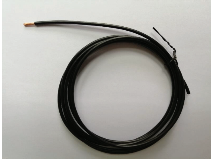
Abbildung 15: Flexible Aderleitung mit Kunststoffummantelung (eigene Aufnahme)
