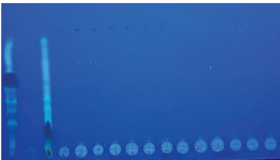
Abbildung 11: DC der Hopfenextrakte und der Biere unter Verwendung von DEE/ Cyclohexan/ AcOH (25:25:1) bei einer Wellenlänge von 366 nm.
