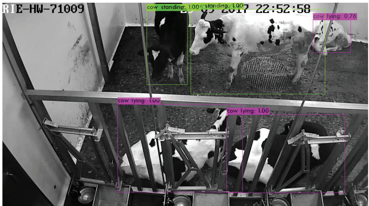
Abbildung 15 Auch auf dieser Grafik identifiziert der Detektor eine zum größten Teil verdeckte Kuh und ist fähig zwei weitere Kühe zu klassifizieren, die durch das Fressfanggitter unregelmäßig verdeckt werden.
