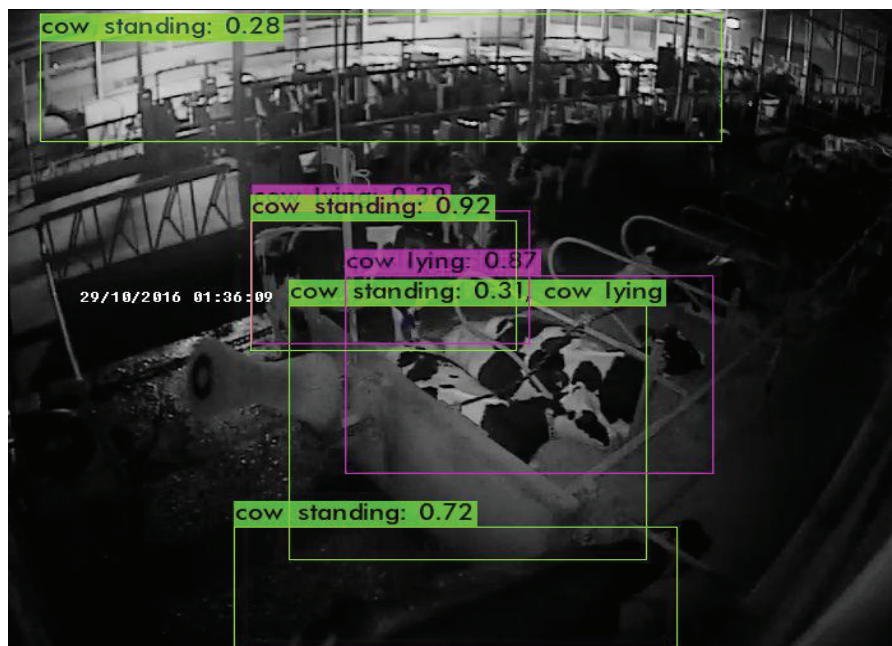
Abbildung 24 Das Objekterkennungsmodell detektiert Stalleinbauten als „stehende“ Kuh.
