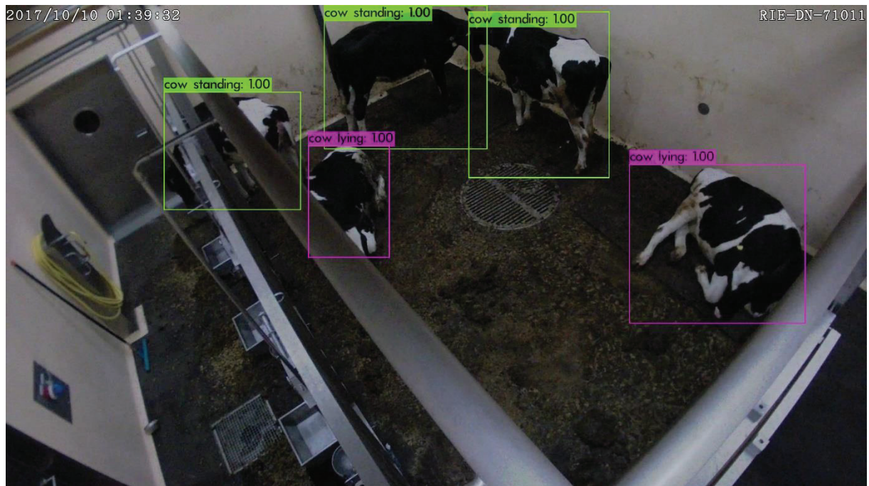
Abbildung 14 Eigenständige Erkennung der Objekteigenschaft durch den Detektor. Die über den Boxen stehenden Informationen sind die Objekteigenschaft und die jeweilige Präzision, mit der sie detektiert wurde.
