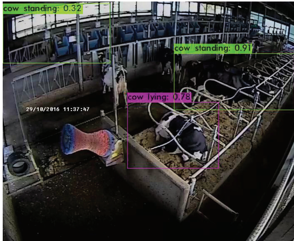
Abbildung 27 Kühe werden nicht oder teils detektiert. Stalleinbauten werden auch hier als „stehende“ Kuh klassifiziert.
