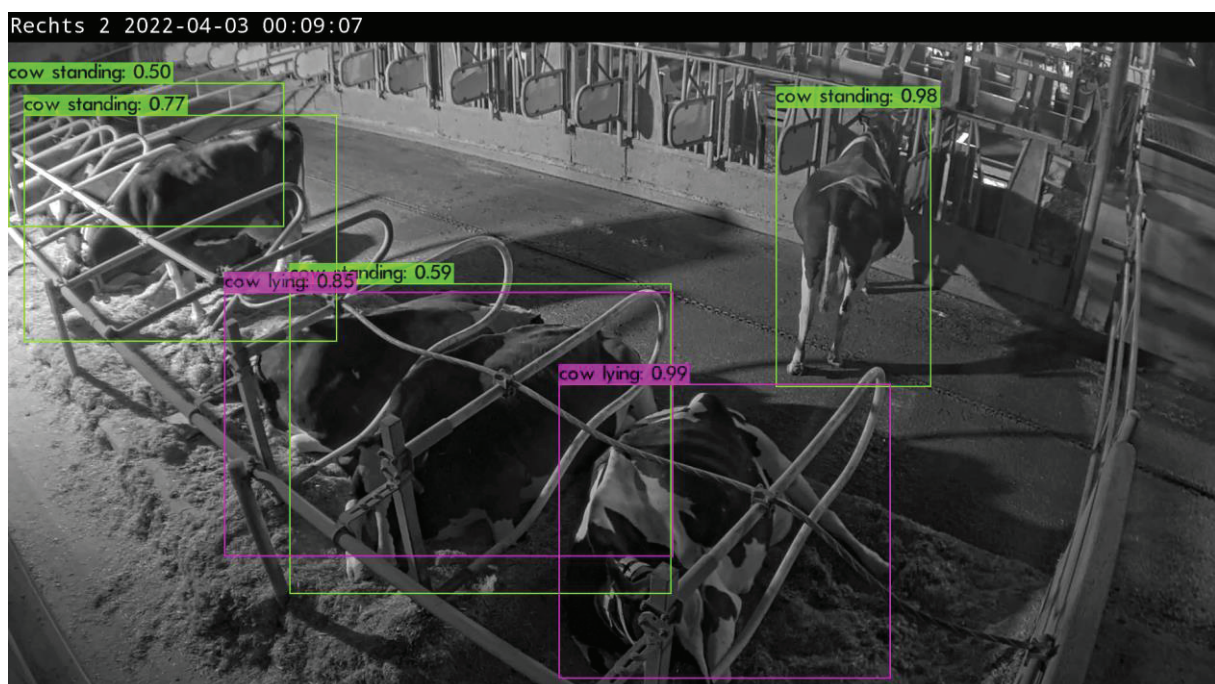
Abbildung 19 Kameraperspektive von der anderen Stallseite. Nähere Kühe werden hinsichtlich der Objekteigenschaft erkannt. Weiter entfernte Kühe werden nicht sicher oder falsch detektiert.
