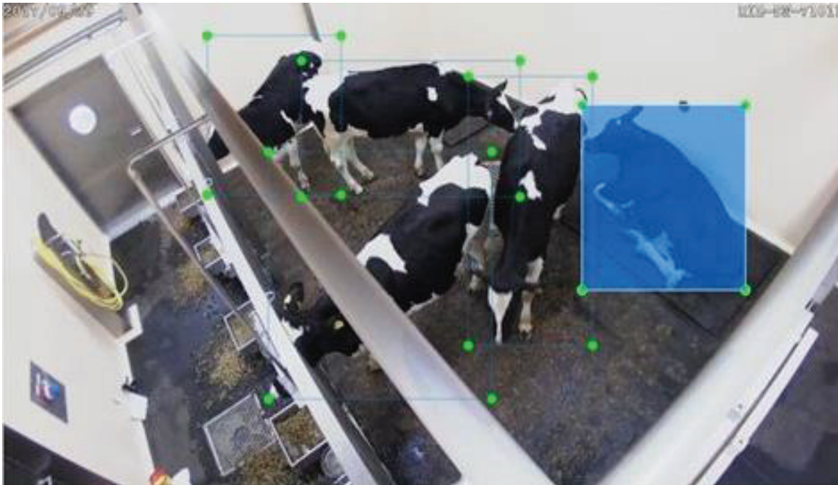
Abbildung 3 Manuelles Labeln der Objekteigenschaften mithilfe von Labellmg. Die Rechtecke umrahmen die Körperflächen der Kühe und werden separat als Koordinaten gespeichert und weiterverwendet.
