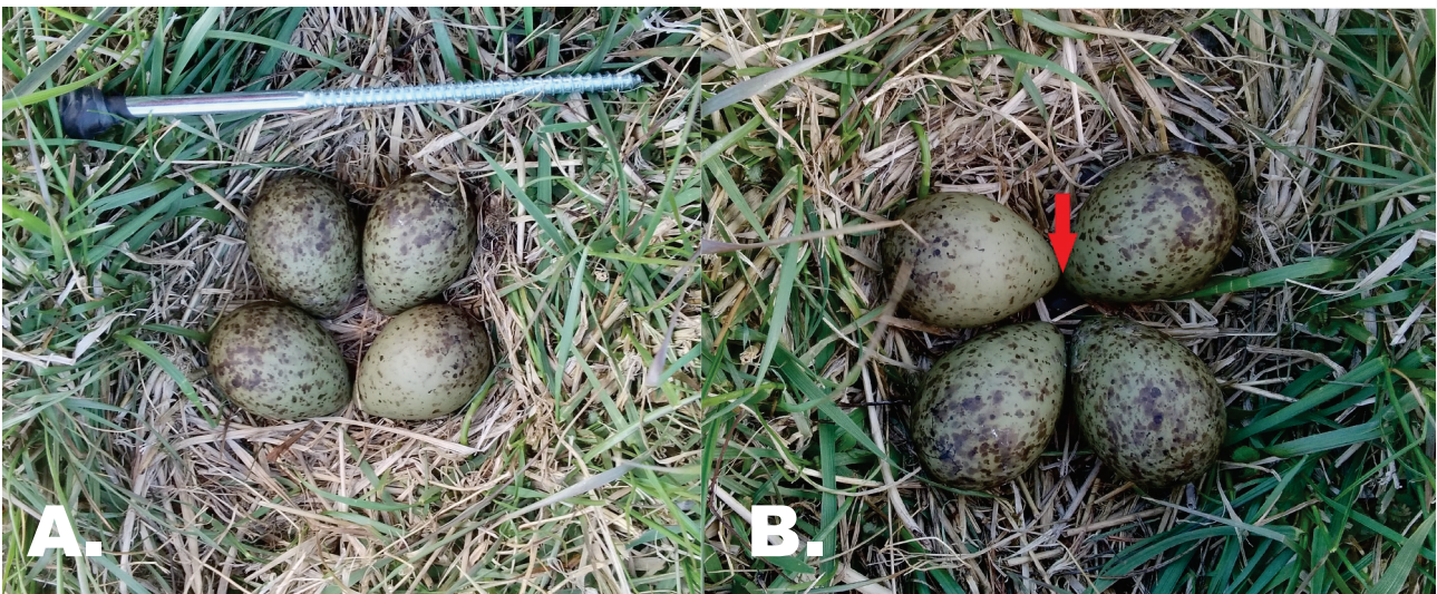
Abb. 10: A. Vollgelege eines Großen Brachvogels ( Numenius arquata ) und ein präparierter Thermologger auf dem Borken (Mecklenburg-Vorpommern) 2022. Der präparierte Thermologger setzte sich je Gelege zusammen aus einer 25 cm langen Edelstahlschraube (OBI-Baumarkt, Eigenmarke) und einem Thermologger (iButton: DS1925L-F# - High-Capacity Temperatur Logger, 122 KB), der mittels selbstverschweißendem, schwarzem Reparaturklebebandes (Coll & Roll: PIB Power Tape) auf dem Schraubenkopf befestigt wurde. B. Ein in ein Nest eingesetzter präparierter Thermologger (roter Pfeil). Die Thermologger wurden möglichst tief mittig im Nest in den Boden gedrückt, sodass der Thermologger knapp über dem Boden herausragte. Die Eier wurden vor dem Einsetzen an die Seite und danach wieder an ihre ursprünglichen Plätze zurückgelegt. Das Einsetzen eines Thermologgers dauerte wenige Minuten, um die Störung des Geleges und der brütenden Altvögel möglichst gering zu halten. Jeder eingesetzte präparierte Thermologger sollte je Nest die Nesttemperatur in °C kontinuierlich alle 5 Minuten erfassen und aufzeichnen. Ergänzend wurden zwei präparierte Thermologger als Referenzthermologger in der Nähe des Weidezaungerätes des großen Kükenschutzzaunes und nicht in Nester eingesetzt. Die Referenzthermologger sollten die allgemeine Umgebungstemperatur im Untersuchungsgebiet aufzeichnen um sie später mit Bebrütungs- und Nesttemperaturen gegenüberstellen zu können. C. Michel.
