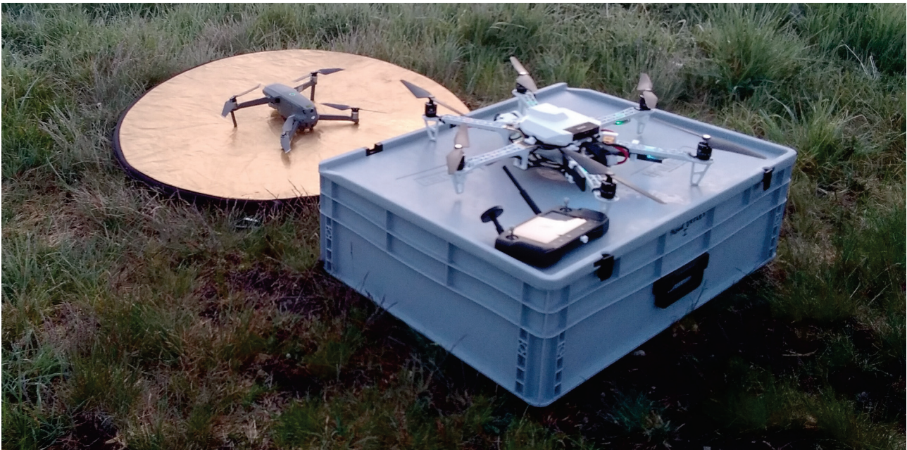
Abb. 13: Die zwei verwendeten Wärmebildkameradrohnenmodelle während der Untersuchungen auf dem Borken (Mecklenburg-Vorpommern) am 26.04.2022, 06.05.2022 und 23.05.2022. Links: Der kleine, graue Quadrocopter „DJI Mavic 2 enterprise advanced“ (M2EA). Rechts: Der große weiße Hexacopter „DJI enterprise advanced: thermal Drones Fliegender Wildretter 640“ (FW2022). Die zwei unterschiedlichen Wärmebildkameradrohnenmodelle wurden für die Untersuchungen gewählt, da sie von unterschiedlicher Größe und Färbung sind. Dadurch sollte das Verhalten der brütenden Großen Brachvögel ( Numenius arquata ) bei zwei unterschiedlichen Wärmebildkameradrohnenmodellen und zwei unterschiedlichen Befliegungsarten („Transektflug“ und „Schwebeflug“) erprobt werden. Beide Drohnen konnten durch eine Fernbedienung (siehe Ecke auf der graue Box) bedient werden. Die Flugrouten wurden zuvor am Computer mit der Software „POI Studio, Version 0.418“ erstellt, konnten jedoch auch manuell an der Fernbedienung ergänzt und geändert werden. Die Wärmebildkameradrohnen starteten und landeten auf der goldglänzenden runden Matte, die als Markierung für die Wärmebildkameradrohne fungierte. C. Michel.
