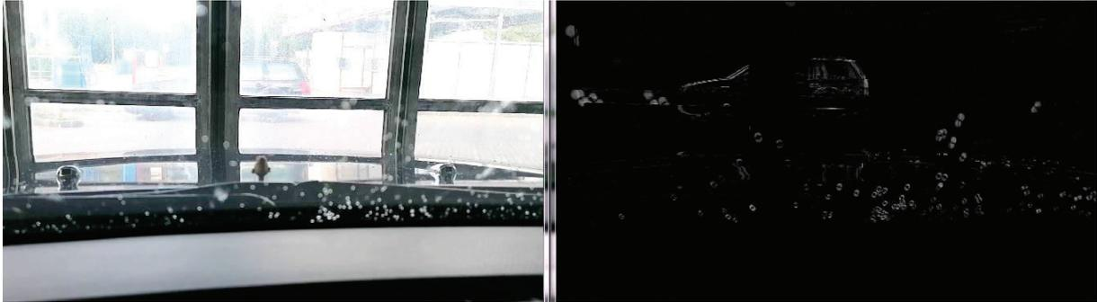
Abbildung 16: Originalaufnahme (links) und Differenz von zwei Bildfolgen der Originalaufnahme (rechts) bei festen Aufnahmestandpunkt, (Eigene Aufnahmen)
