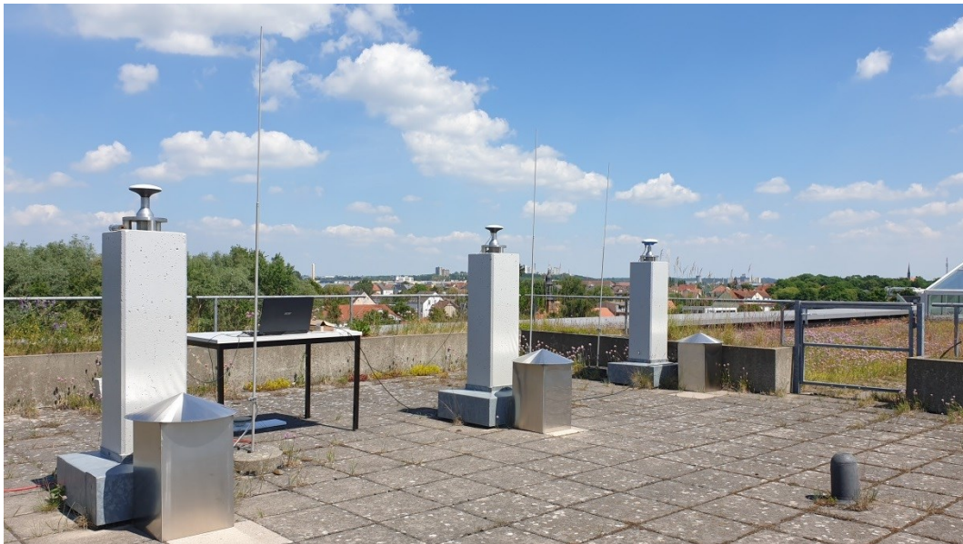
Abbildung 3-14: Versuchsaufbau zur Kontrolle der Phasenzentrumsoffsets (2 x AS-ANT2B-SUR und 1 x NAX3G+C)
