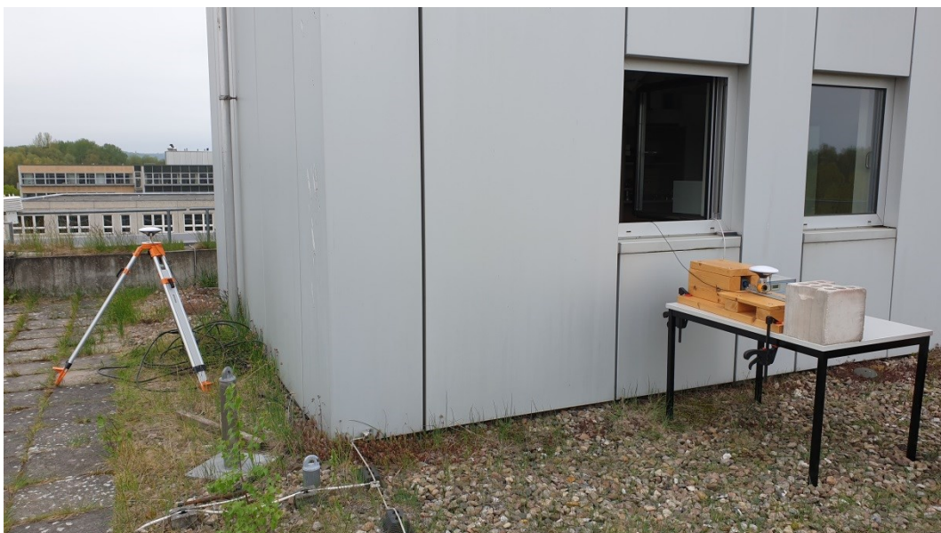
Abbildung 3-16: Versuchsaufbau zur Erfassung von Deformationen unter schwierigen Empfangsbedingungen
