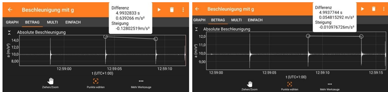
Abbildung 3-5: Prinzip der ereignisbasierten Synchronisierung bei Smartphones (S9 vs. A51)
