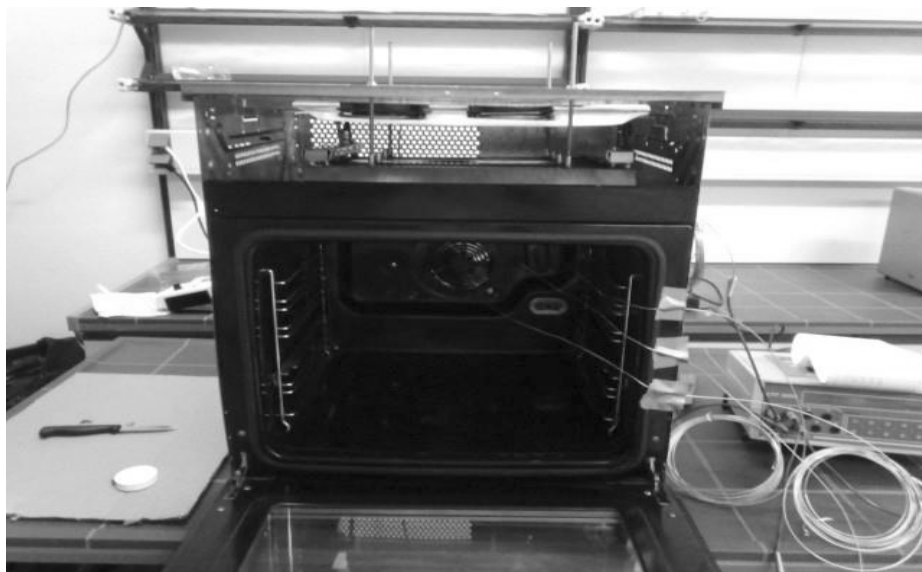
Abbildung 6: Anordnung der Wärmesensoren im Untersuchungsraum
