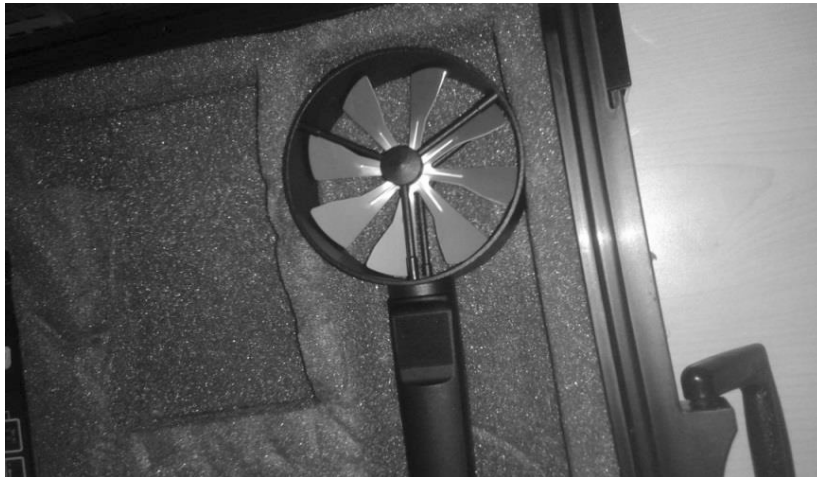
Abbildung 3: testo term 452 Luftstrommesser
