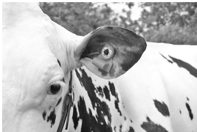
Abbildung 5: Ohrsensor von CowManager (CowManager, 2020)
