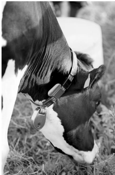
Abbildung 4: Halssensor von DeLaval (Quvarford, B., 2020)
