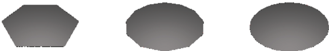
Abbildung 3: Durch Eckpunkte bedingte Form eines Kreises. Die Kreise besitzen den gleichen Durchmesser und sind (von links) durch 6, 12 bzw. 24 Eckpunkte definiert. Werden die Kreise von links nach rechts betrachtet entspricht das in etwa einer Multiplikation der jeweils vorangegangenen Größe mit zwei. Jeder Kreis hat den Durchmesser einer Blender Unit.
