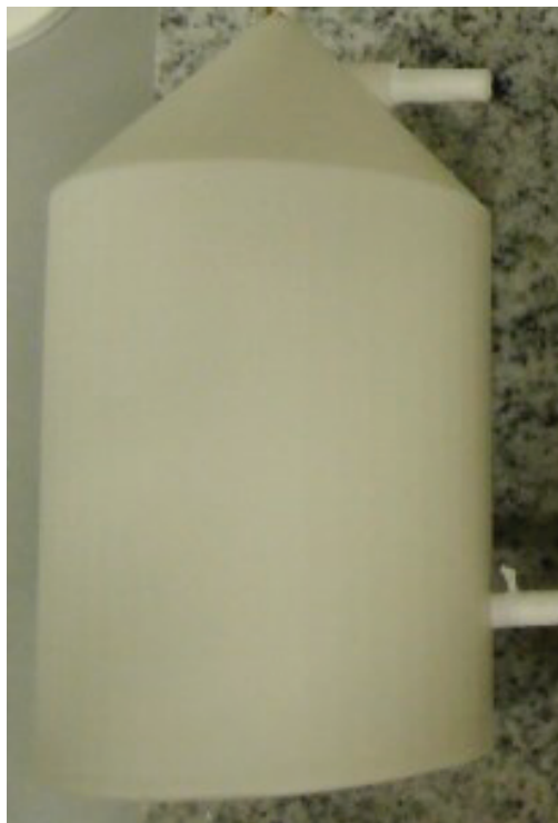
Abbildung 35: Wasserdichter Zylinder PLAHT, optimiertes Design mit Gewindebohrung. Der Zylinder besitzt eine Schichthöhe von 0,2 mm und wurde mit der großen Fläche (Abbildung unten) auf dem Druckbett stehend gedruckt. Durch die langsame Druckgeschwindigkeit ergab sich eine Druckzeit von rund 70 Stunden. Der Zylinder ist mit eingeschnittenem Gewinde (Abbildung oben) ohne weitere Nachbearbeitung wasserdicht.
