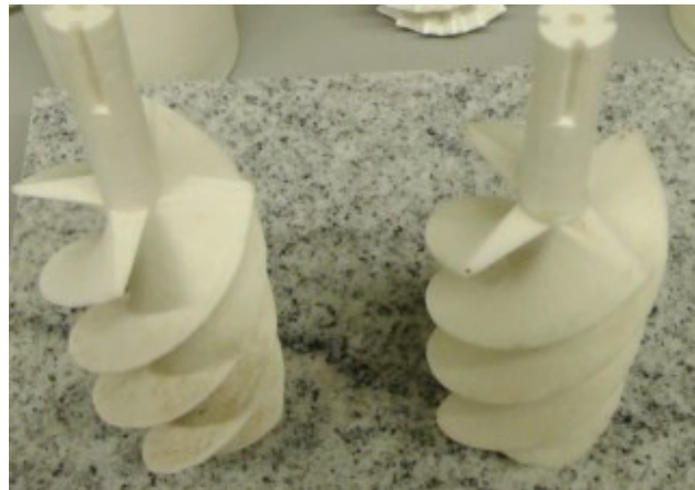
Abbildung 40: Förderschnecken rechts PLAHT, links PLA.
