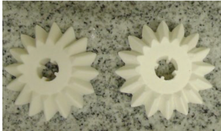
Abbildung 38: Kegelräder links PLAHT, rechts PLA.
