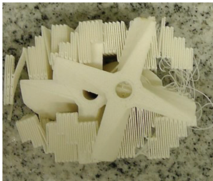
Abbildung 53: Mechanisch bedingter Versatz. Der abgebildete Versatz entstand durch eine gelöste Fixierung, dabei kann sich die Riemenführung bei schnellen Bewegungen um den Fixierungsbolzen drehen.
