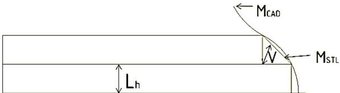
Abbildung 5: Das Konzept der Zackenhöhe 2 . Die gekrümmte Linie MCAD stellt den Verlauf des CAD-Modells im Zeichenprogramm dar. Durch die Triangulation der Oberfläche (STL-File) ergibt sich die Form aus Geraden (MSTL). Beim Slicen wird diese Form in einzelne Schichten aufgeteilt, die jeweils der physikalischen Schichtdicke ( L_h ) entsprechen. Die Höhe der Schicht bedingt, dass eine Schräge nicht exakt abgebildet werden kann. Der Abstand zur Schräge ( V ) entspricht der beim Druck entstehenden „Zackenhöhe“.
