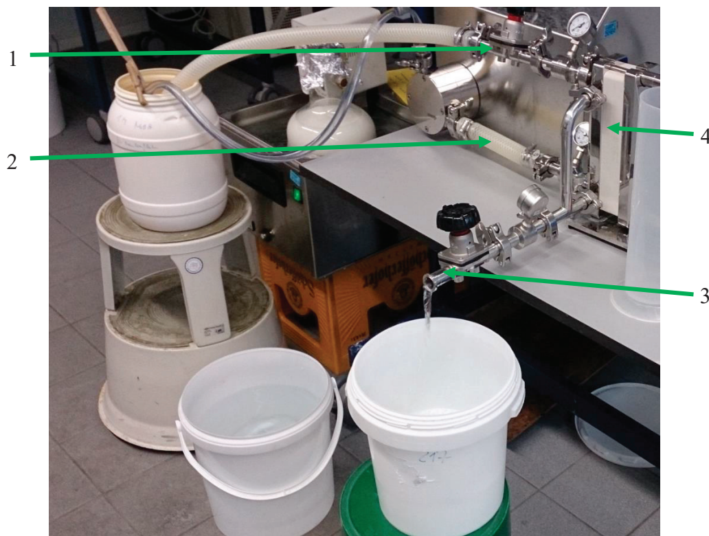
Abbildung 3-2: Aufbau des Versuchstandes zur Membranfiltration. (1) Retentatauslass, (2) Feedeinlass (in diesem Fall Retentateinlass), (3) Permeatauslass, (4) Membranen.
