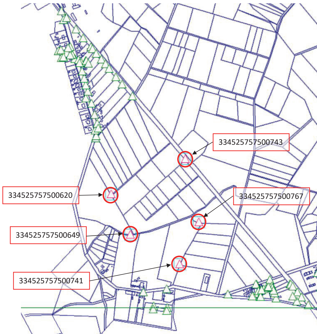
Abbildung 10-9: Auswahl der vorgefundenen Passpunkte zur Untersuchung der nötigen Quantität der Passpunkte (rote Kreise = ausgewählte Punkte; rote Dreiecke = Passpunkte; grüne Dreiecke = Altpunkte)
