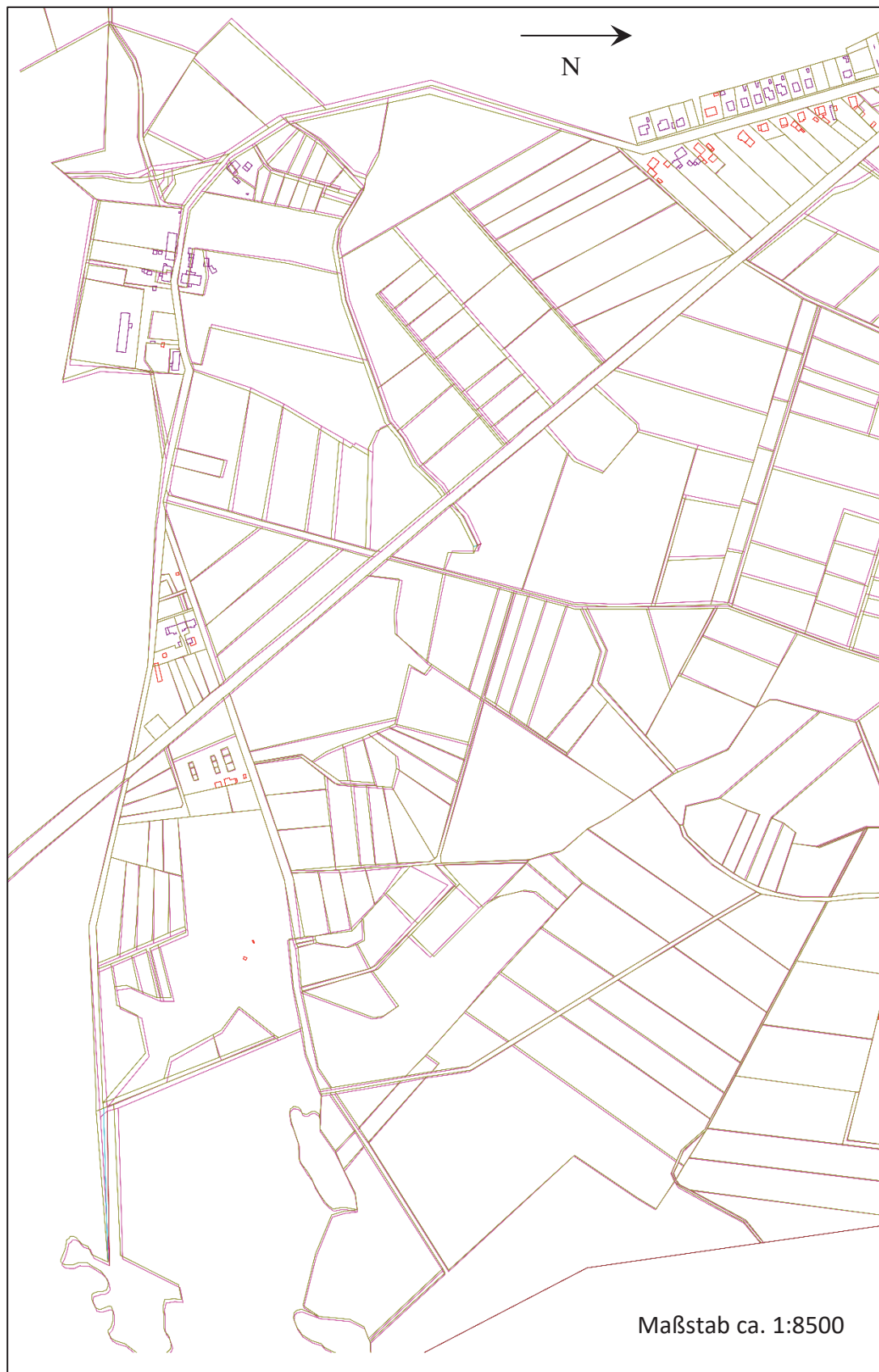
Abbildung 11-1: Schwarz - Rot Plot südlicher Teil der Projektgebietes (grau = Grenzverlauf vor Ausgleich; rot = Grenzverlauf nach Ausgleich)
