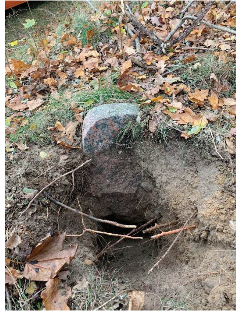
Abbildung 10-4: Vorgefundene Abmarkung des Punktes 334535757204012
