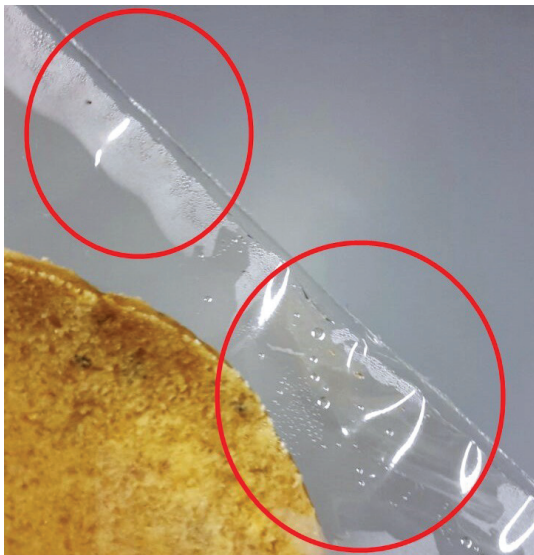
Abbildung 10: Ansammlung von Kondenswasser auf der Innenseite der PLA-Folie nach 14 Tagen Lagerung
