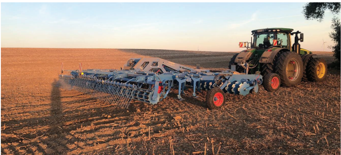
Abbildung 8: Lemken Koralin im ausgeklappten Zustand in der Rapsstoppel (Foto: Florian David, 2020)
