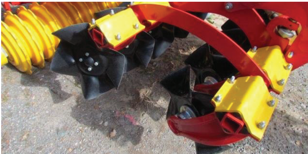
Abbildung 4: Sicht auf die CrossCutter-Disc der Carrier (Foto: Florian David)
