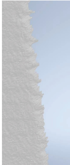
Abb. 17: Kante eines Referenzkörpers ohne Filterung
