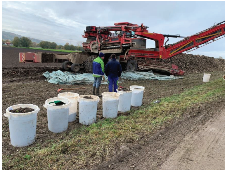
Abbildung 13: Versuchsaufbau mit Vlies unter dem „VarioCleaner“ und Versuchskübeln. Quelle: Eigene Aufnahme, 2019
