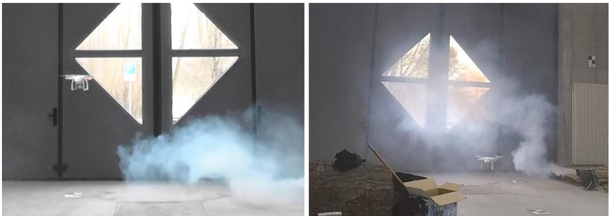
Abbildung 15 - Bodeneffekt der DJI Phantom 3 Pro
