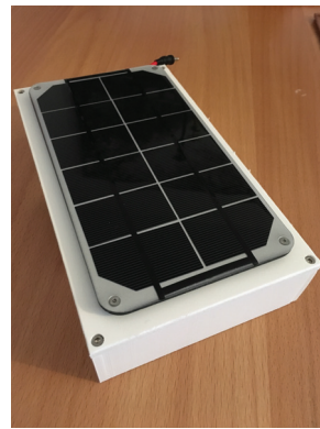
(c) Solar-Modul auf dem Gehäuse
