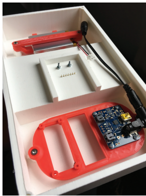
(a) Befestigungen für Akku, Ladegerät und Mikrocontroller
