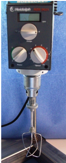
Abbildung 17: elektrisches Rührelement im variabler Umdrehungseinstellung
