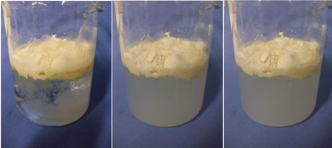
Abbildung 24: Benetzungsverhalten von WPC 60 nach 0 s, 30 s und 60 s (v.l., bei Raumtemperatur)
