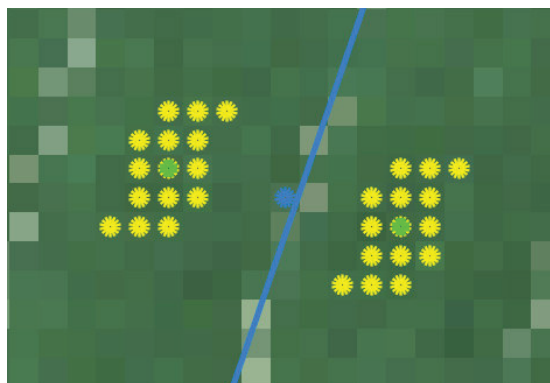
Abbildung 41: Detektion der Bestandspixel (grün) zu beiden Seiten eines Fahrgassenpixels (blau) unter Berücksichtigung einer definierten Pixelumgebung (gelb).
