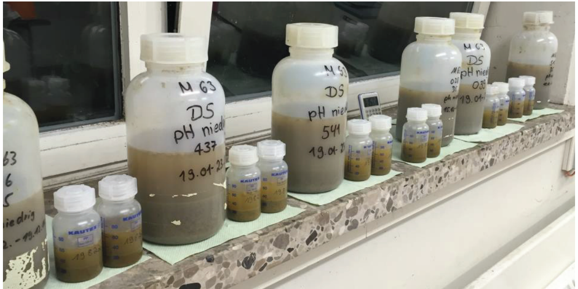
Abbildung 6: Probenaufbereitung und Prüfung der Repräsentativität zur Ausgangsprobe des abgefüllten Probenmaterials.
