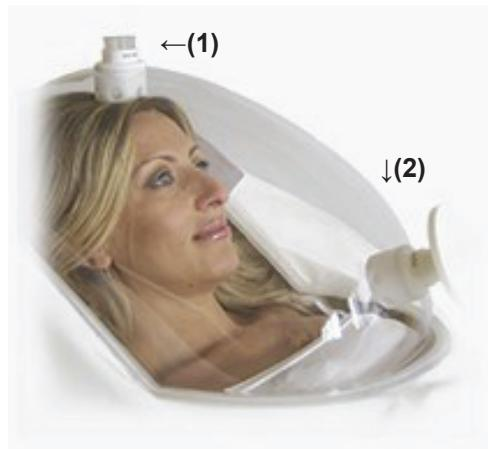
Die Haube verfügt über zwei Öffnungen. Die obere Öffnung (1) ist ein reines Einlassventil. Durch diese Öffnung kann keine Luft nach außen gelangen. An der unteren Öffnung (2) wird der Schlauch befestigt, welcher das Gasgemisch in das Quark RMR saugt.
