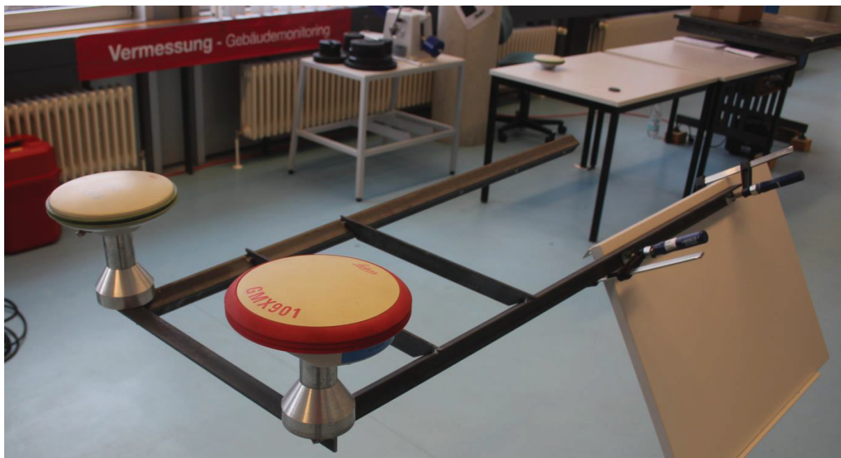
Abbildung 3.6: Rohfertigung der Halterung mit GNSS Antennen
