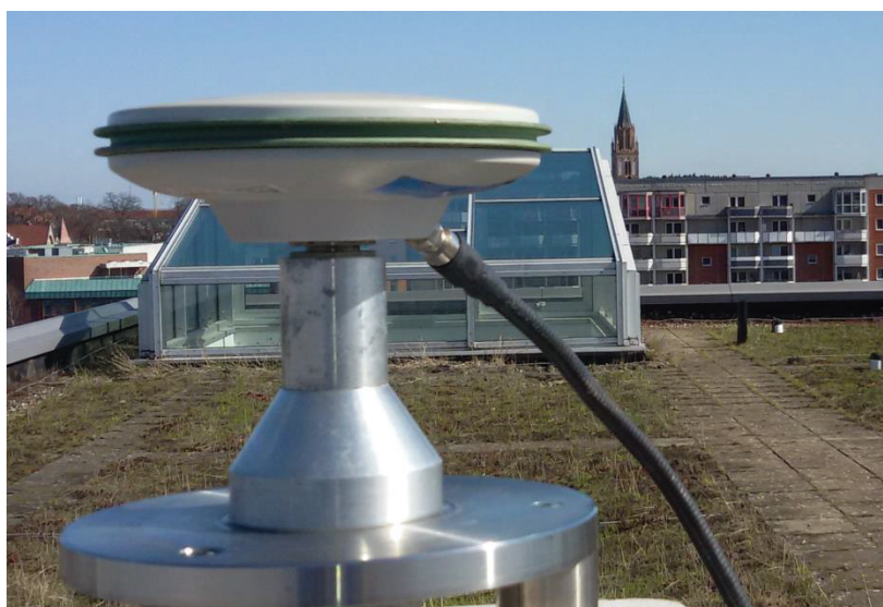
Abbildung 6.3: GNSS Basisstation mit Blick auf die Marienkirche
