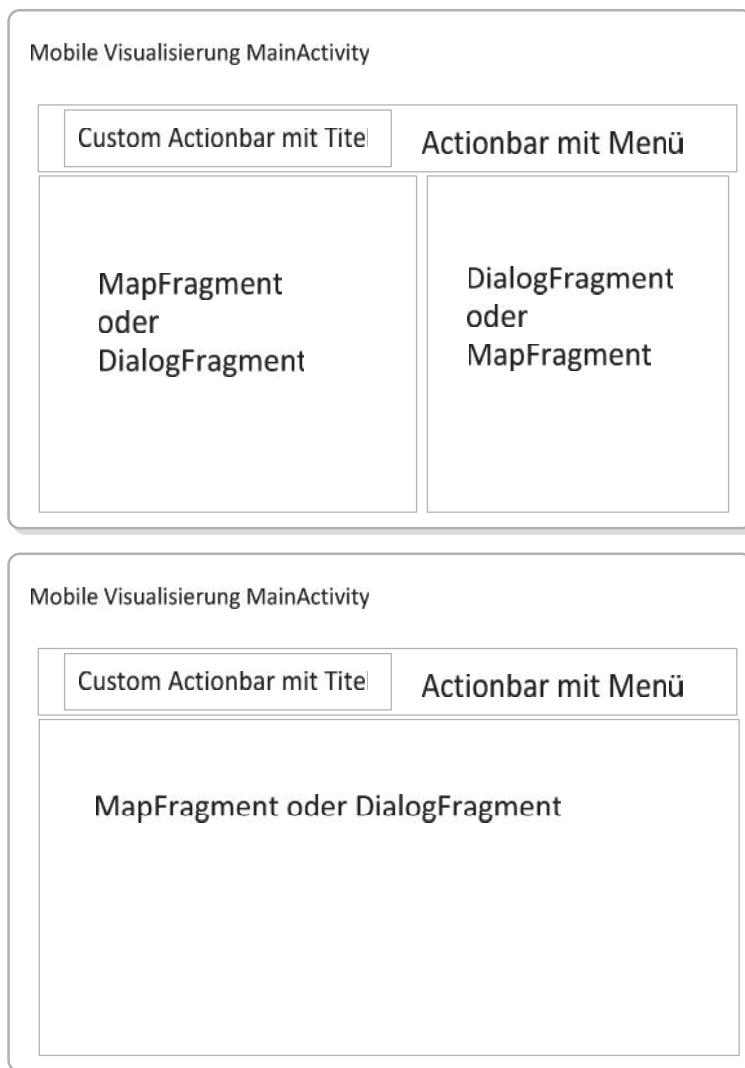
Abbildung 27: Nutzeroberfläche in Android Implementierung
