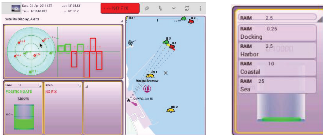
ABBILDUNG 45: WEITERE DIALOGE (SATELLITEN OBEN UND ALARME UNTEN), RECHTS: RAIM
