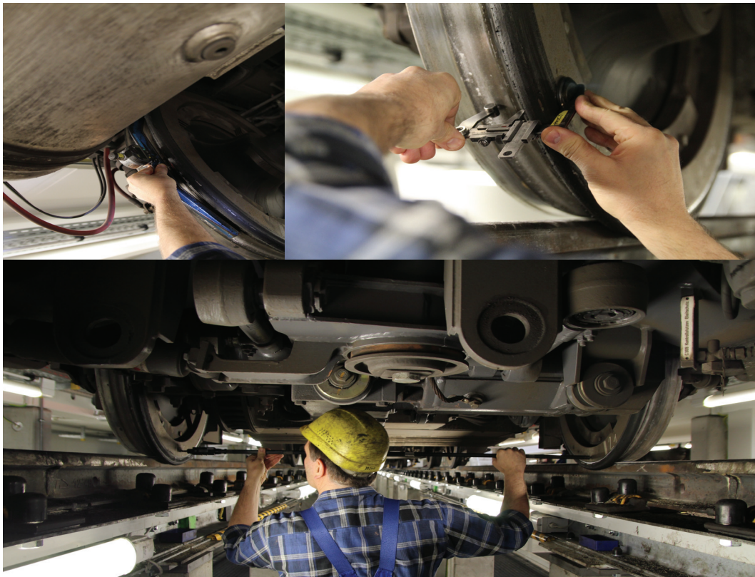
Abbildung 6: Messungen an Achse Drehgestell; Radrückenabstand (unten); Radgeometrie (oben)
