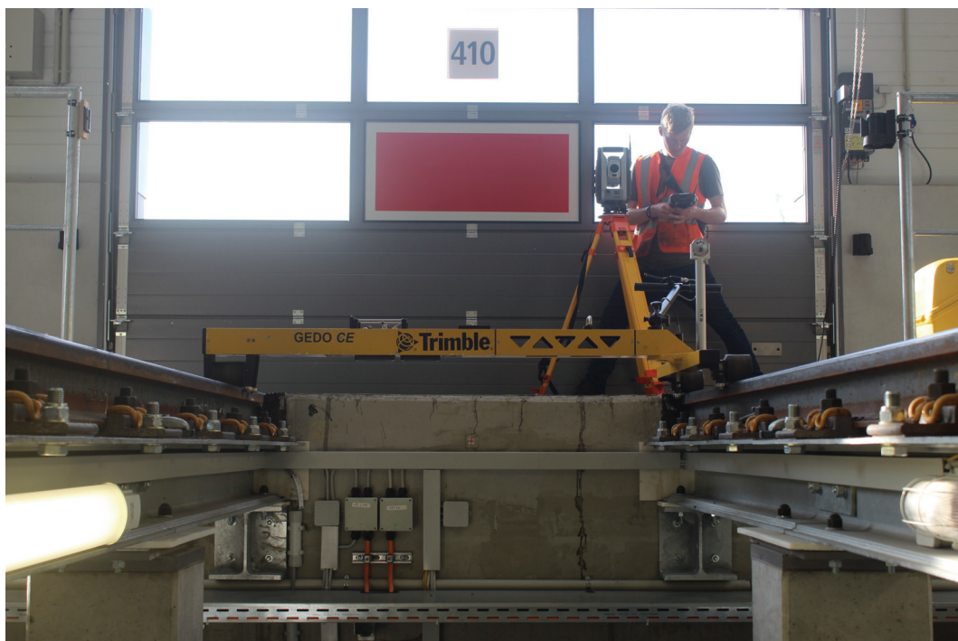
Abbildung 22. Gleismesswagen GEDO CE 2.0, Trimble S8 St.Pkt Tor, TSC3 Controller
